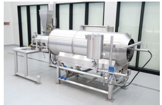
El rociador de aceite con sistema de pulsos MS-I como parte del sistema de recubrimiento en dos etapas.
