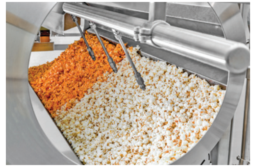
Barra de rociado con boquilla remota y boquillas con obturadores autoajustables. Logre una aplicación de rociado precisa cuando se utiliza en un tambor de recubrimiento.
